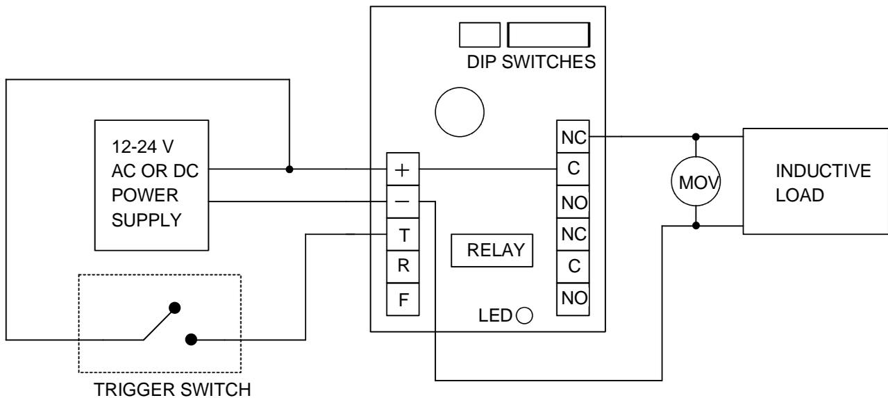
IN THIS CIRCUIT, THE LOAD TURNS OFF WHEN THE TIMEMASTER RELAY ENERGIZES
