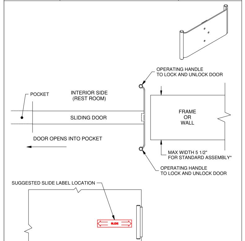
\*CUSTOMIZED ASSEMBLIES CAN BE MADE FOR WIDTH'S GREATER THAN 5 1/2"
